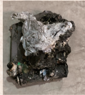
発煙や発火の原因となった 焼けたリチウムイオン電池
