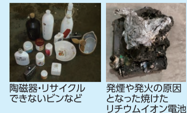
陶磁器・リサイクルできないビンなど 発煙や発火の原因となった焼けたリチウムイオン電池
