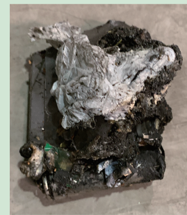
発火の原因となった焼けたリチウムイオン電池
