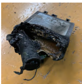
発火の原因となったコードレススティック掃除機のバッテリー
