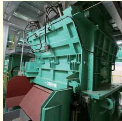
一次破砕機 1st Crusher
